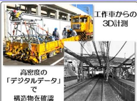
移動体レーザ計測 (MMS) による
